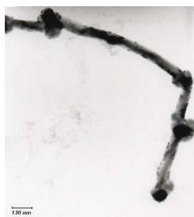
شکل ۷: تصویر TEM مواد هیبریدی CdSe NPs-TGA/ NH 2 -MWCNTs
