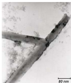
شکل ۵: تصویر TEM نانولوله کربنی عامل‌دار شده.
